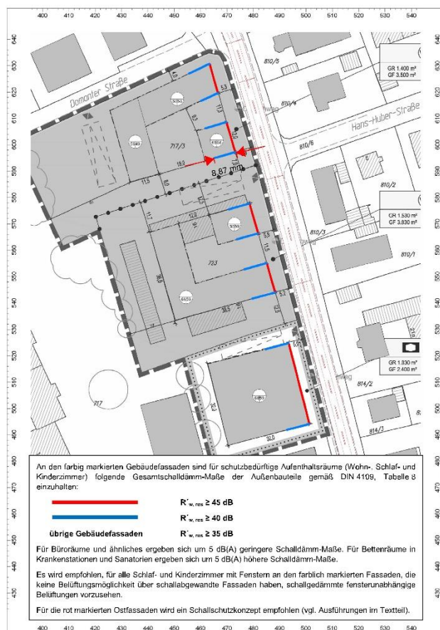
Abb. 12: Gesamtschalldämmmaße der Außenbauteilflächen
