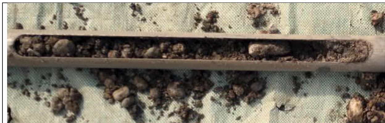
Abbildung 8: KRB4/2,5-3,5: Auffüllung; Fremdbestandteile Ziegelbruch, Schlacke
