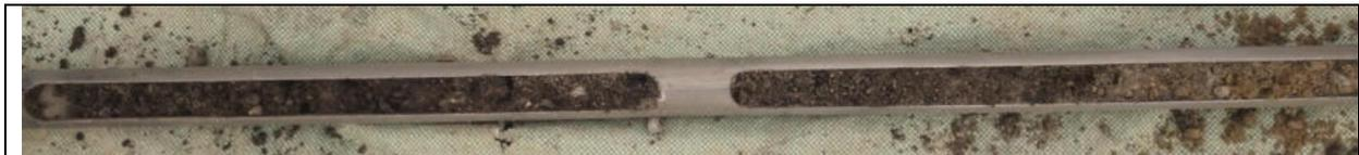
Abbildung 11: KRB5/5,0-6,0: Auffüllung; Fremdbestandteile Brandrückstände, Holz
