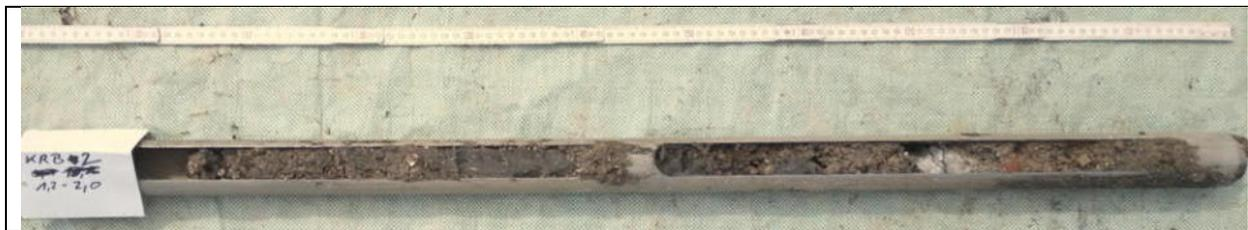
Abbildung 3: KRB2/1,2-2,0: Auffüllung; bindiges Material, Fremdbestandteile Ziegelbruch und Schlacke
