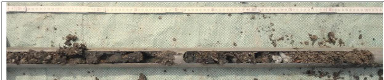
Abbildung 4: KRB2/4,0-5,0: Auffüllung; Fremdbestandteile verwittertes Holz
