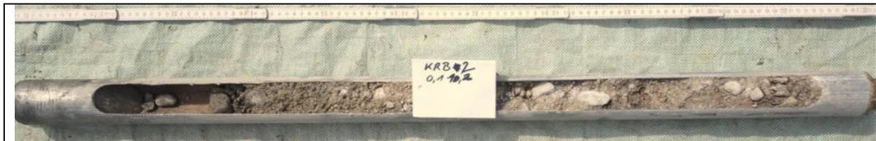
Abbildung 2: KRB2/0,1-0,7: Auffüllung; Kies, sandig, sehr schwach schluffig
