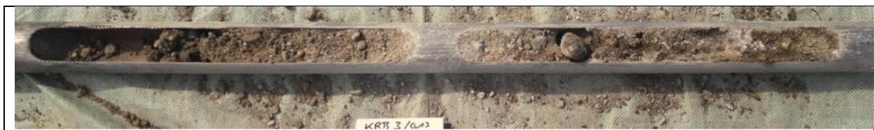
Abbildung 5: KRB3/0,13-1,0: Auffüllung; Fremdbestandteile Ziegelbruch ab 0,4 m
