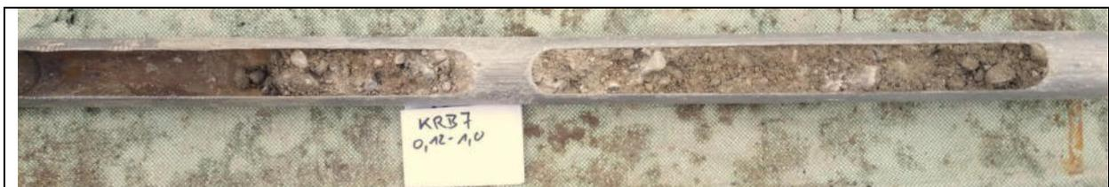
Abbildung 15: KRB7/0,12-1,0: Auffüllung; Kies, sandig, sehr schwach schluffig
