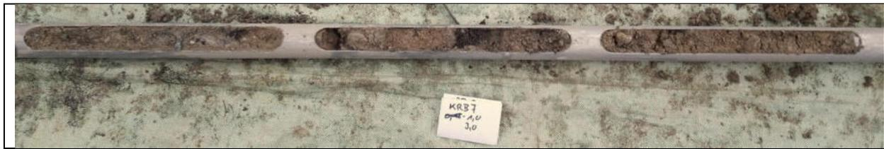
Abbildung 16: KRB7/2,0-3,0: Auffüllung; Fremdbestandteile lokal Einschlüsse mit Brandschutt
